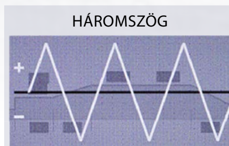
Háromszög hullámalak Jobb beolvadás, mint Sinus hullámalak esetén
