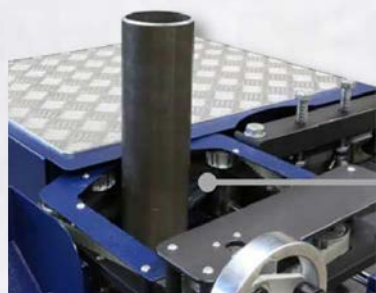
csövek él- lőkészítése
