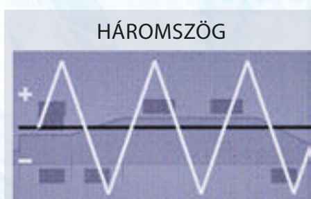
Háromszög hullámalak Jobb beolvasás, mint Sinus hullámalak esetén
