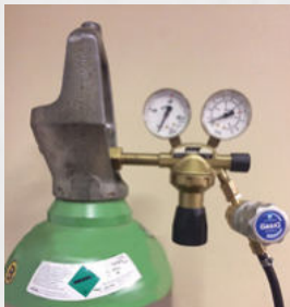
Gázpalack a nyomáscsökkentővel és takarékszeleppel
