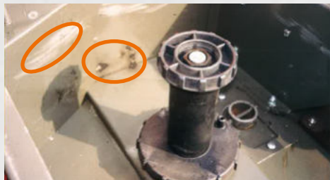
a huzalelőtoló belsejében látható kopási és zárlati nyomok
