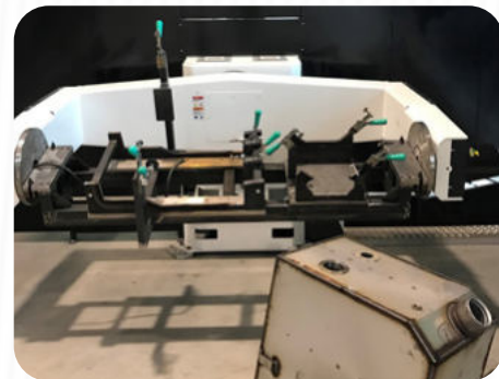
7. kép: Az 5-tengelyes pozícionáló és az első készre hegesztett tartály
