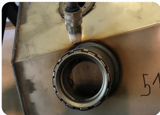
5-6. kép: Tartályvarratok hegesztése, OTC AC/MIG eljárással
