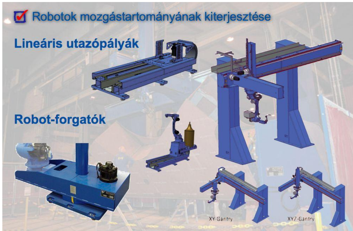
1. ábra: hegesztőrobot munkaterének kiterjesztése nagyméretű munkadarabok hegesztéséhez
