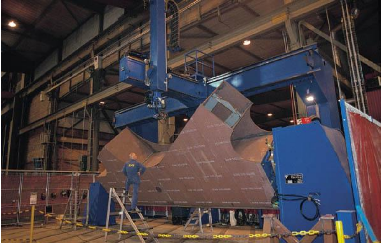
6. ábra A MOTOMAN robotrendszere, 20 tonna terhelhetőségű pozicionáló berendezéssel
