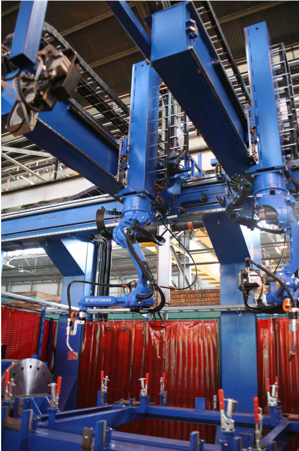
3. ábra: A legutóbbi és legnagyobb Motoman hegesztő robotrendszer képe, mely a Wagon Build gyárban került telepítésre, Bleomfontein-ben, Dél-Afrikában.
