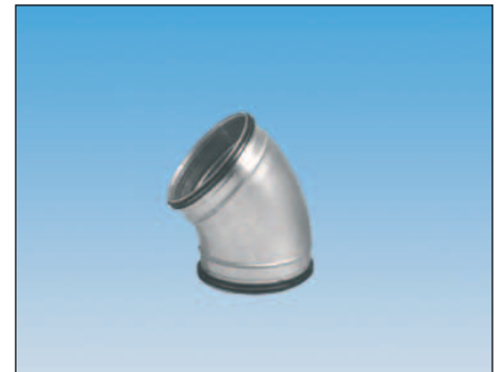
Csőkönyökök, 30° sajtoltva és hegesztve Ø 355 mm-től kezdve szegmenses felépítésben.
