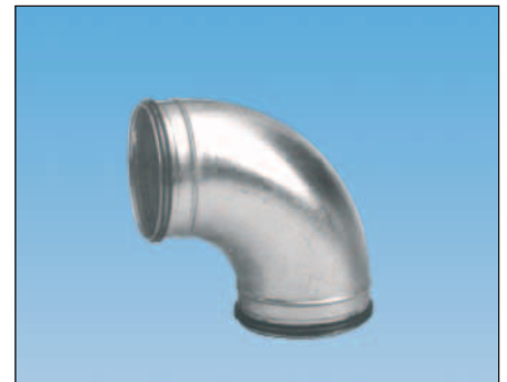
Csökönyökök, 90° sajtoltva és hegesztve Ø 355 mm-től kezdve szegmenses felépítésben.
