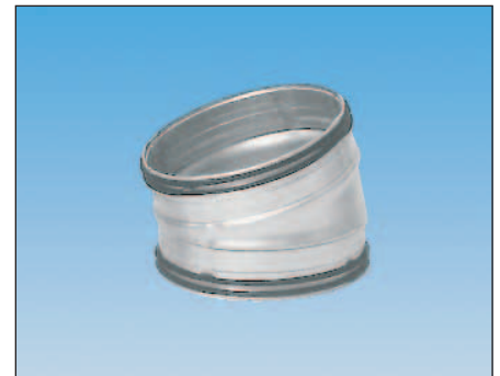
Csőkönyökök, 15° sajtoltva és hegesztve Ø 355 mm-től kezdve szegmenses felépítésben.
