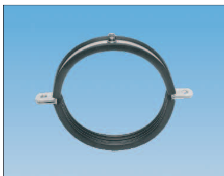
Csőbilincsek kétrészes, horganyzott acéllemezből, gumibetéttel, 25 x 2 mm-es. M8-as menetes hüvellyel
